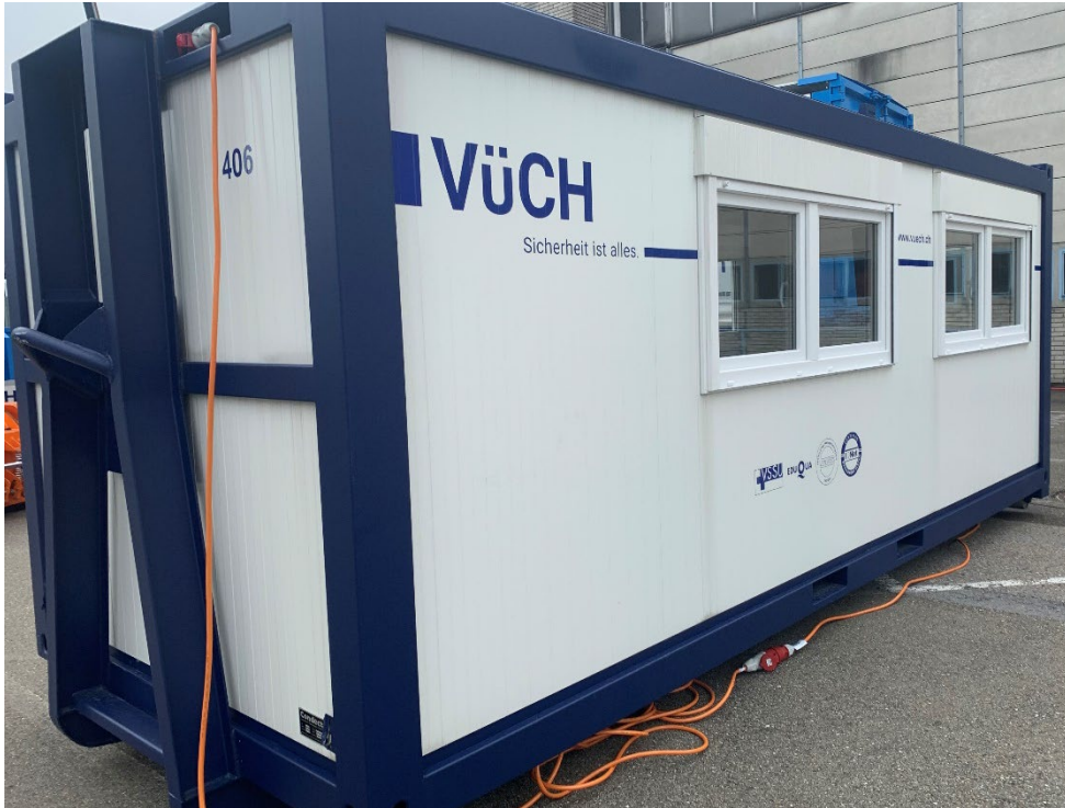
L 6.05 m B 2.43 m Abrollcontainer, Leergewicht: 2400 kg
